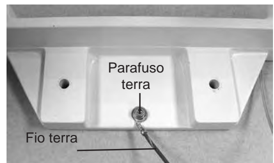
Figura SU-3 Aterramento do apoio para queixo
