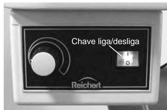
Figura SU-13 Conjunto da fonte de alimentação
