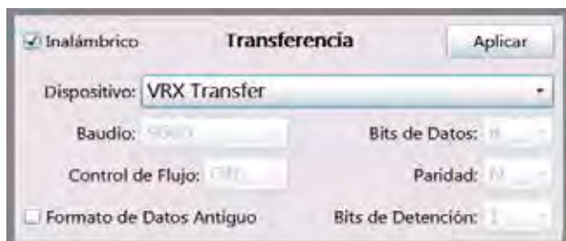
Figura IS-19, Configuración de puertos para transferir datos de una unidad VRx a otra
