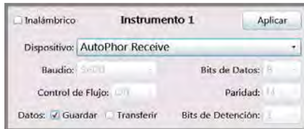
Figura IS-20, Configuración de puertos para recibir datos del VRx anterior en una cadena margarita
