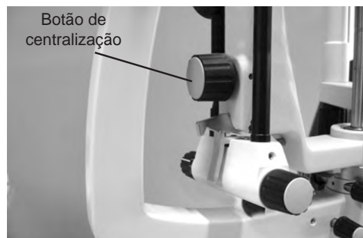
Figura IN-11 Centralização da fenda
