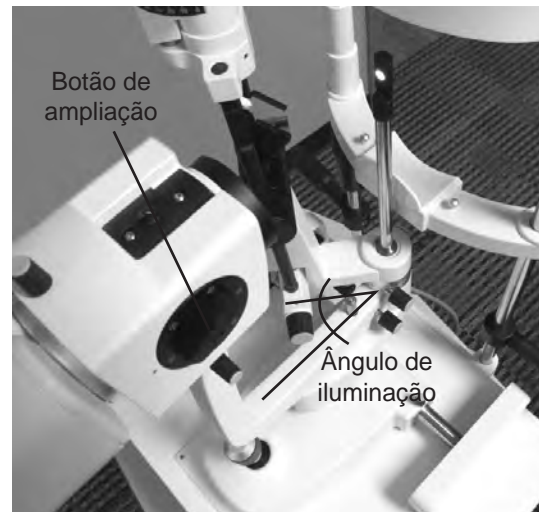
Figura IN-5 Ângulo de iluminação
