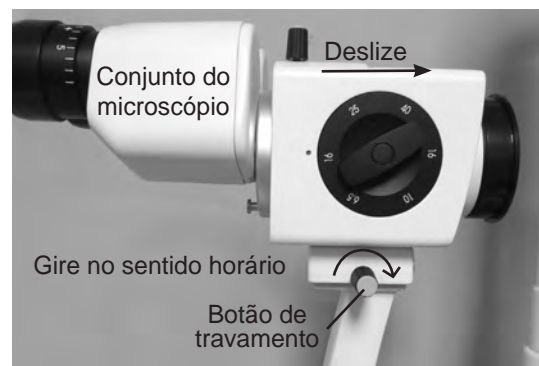
Figura SU-13 Instalação do microscópio
