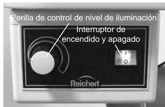
Figura SU-14 Conjunto de suministro eléctrico
