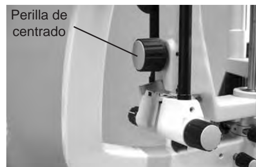
Figura IN-11 Centrado de la hendidura
