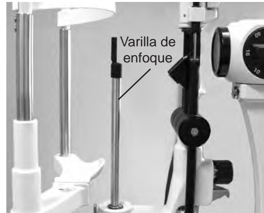
Figura IN-1 Instalación de la varilla de enfoque
