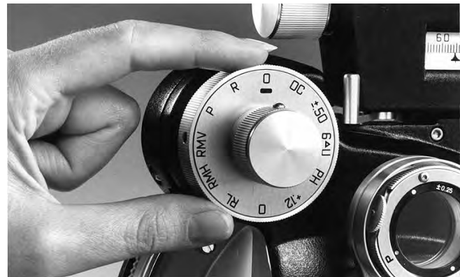
Figura TM-4 Rotación del control de esfera fuerte (rodea la escala de lentes auxiliares)
