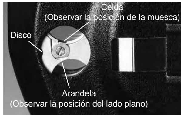
Figura MM-5 Disco auxiliar - Foróptero antiguo (Celda extraíble, vista a través de la parte posterior de la apertura principal)
