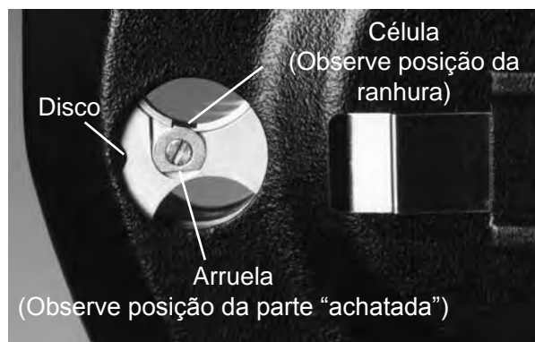
Figura MM-5 Disco auxiliar – Antigo (Célula removível vista através da parte traseira da abertura principal.)
